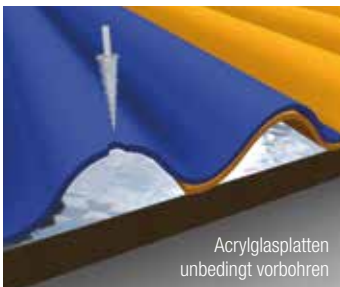
Querschnitt: Befestigung vor der Überlappung
